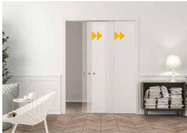
Aplicable a los modelos TELESCÓPICA y TELESCÓPICA extensión\* permite el movimiento de dos puertas empotrables en la misma dirección: la primera puerta "engancha" la segunda y los dos paneles deslizan juntos, sin tirones. Se coloca directamente en el panel de la puerta (sin quitar la guía extraíble) y se adapta a los modelos Telescópica con luz de paso de mm 600+600 hasta mm 1200+1200.
